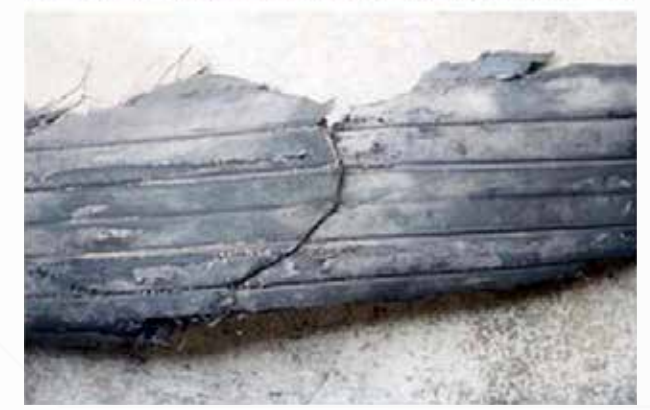
Şekil 1: Air France Concorde Kazası ve Concordu Düşüren FOD
