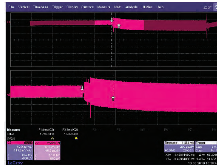
Şekil 5. FSM3000A'nın frekans atlama hızı.
