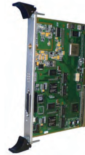
Şekil 5. SGS ve ÇİTA'nın üzerinde koştuğu sinyal işleme modülü USİM-01.
