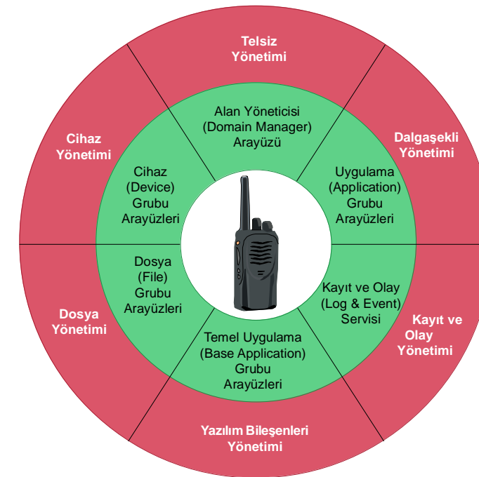
Şekil 2. SCA arayüzleri ile telsiz işlemleri arasındaki ilişki.
