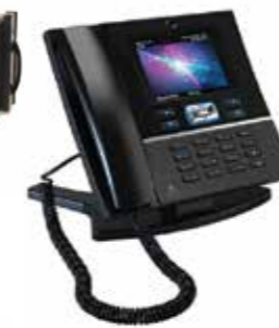
MİLSEC-4: Emniyetli ses ve görüntülü konuşma için kullanılan VoIP (Voice over IP) Kripto Cihazı
