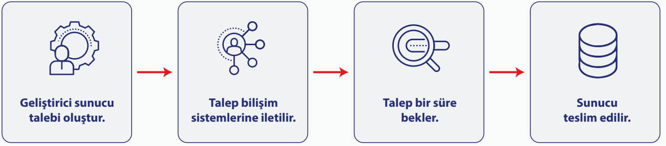
Şekil 1. Bulut Sağlayıcı Kullanmayan Veri Merkezinde Yaşanan Sunucu Teslim Süreci
