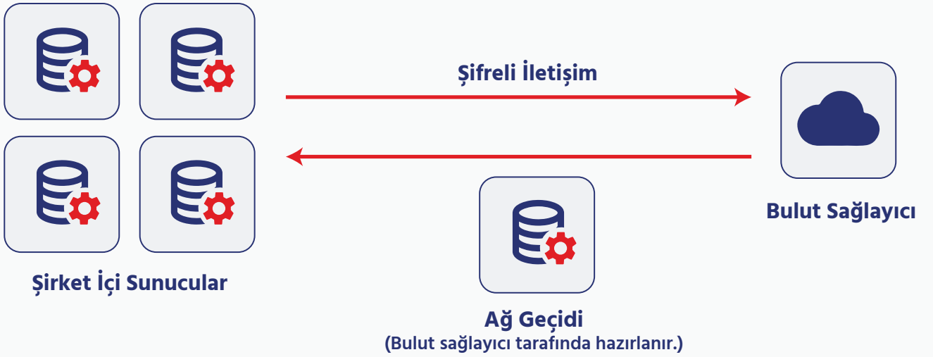
Şekil 3. Ağ Geçidi ile Sağlanan Hibrit Depolama Yöntemi
