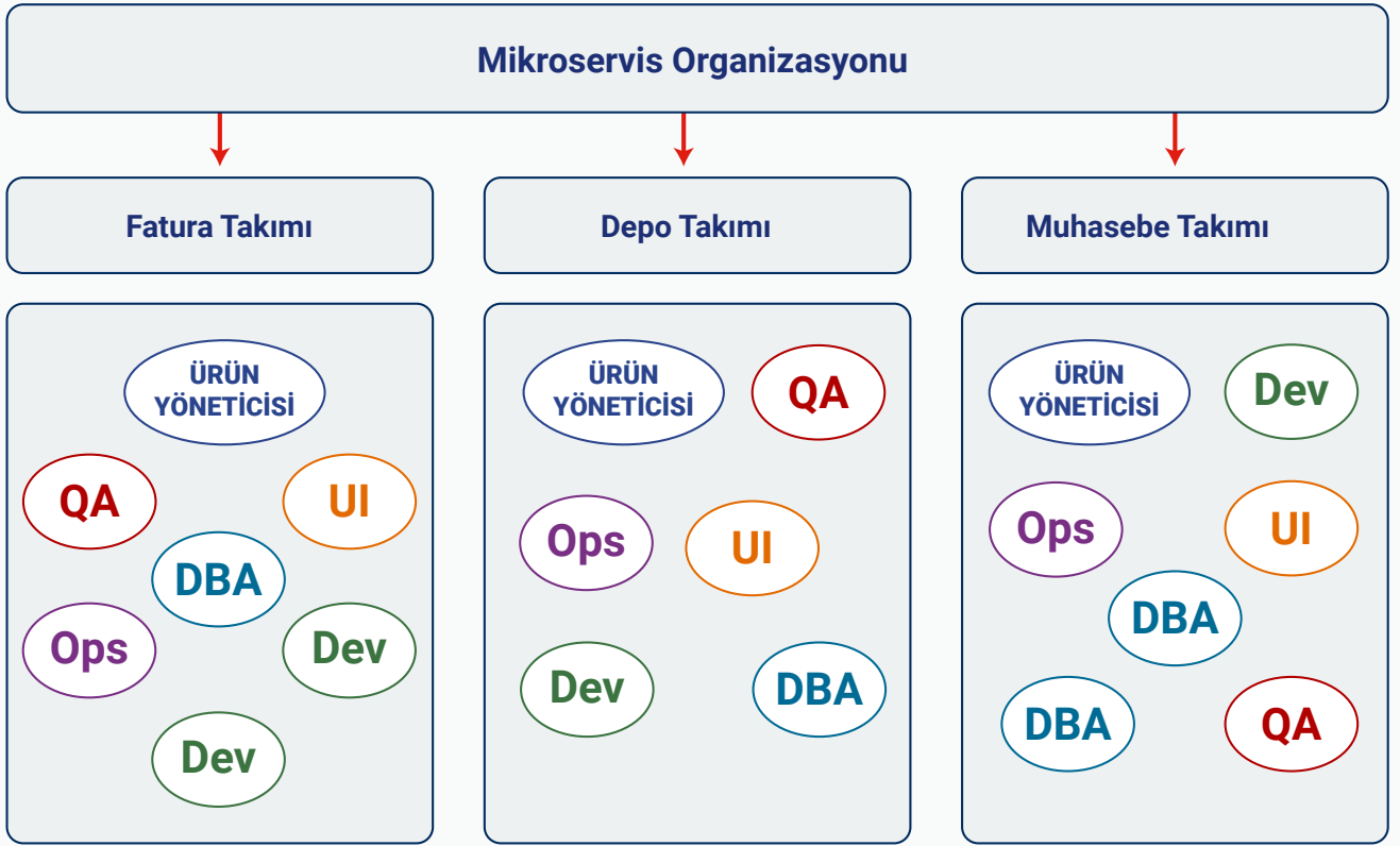
Şekil 10. Mikroservis Mimari Tarafından Desteklenen Organizasyon Yapısı
